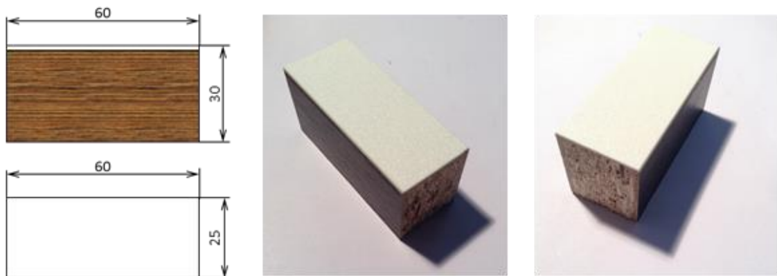
Obr. 28, 29, 30 Skúšobné vzorky a ich rozmery
