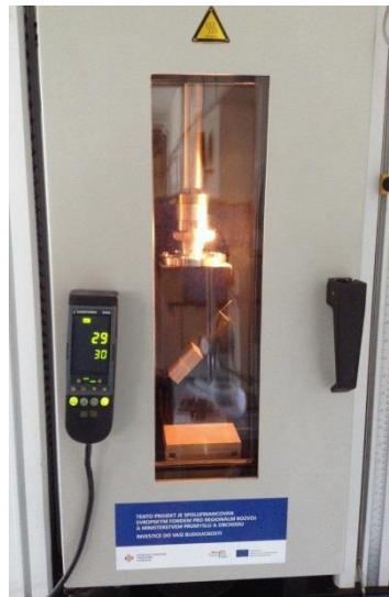
Obr.24 Tepelná komora INSTRON model 3119-409-22
