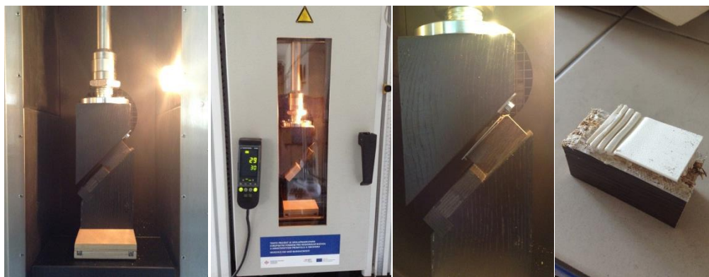
Obr. 35, 36, 37, 38 Vloženie vzorky do komory, uzatvorenie komory, vybratie vzorky po skúške a následné zdokumentovanie vzorky
