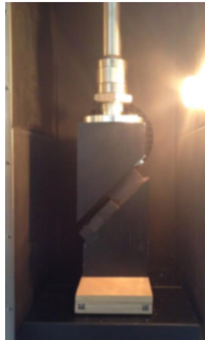
Obr. 23 Skúšobný agregát pre šikmý tlakový šmyk
