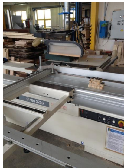
Obr.31, 32 Kotúčová deliaca píla s predrezom v dielni Mendelovej univerzity
