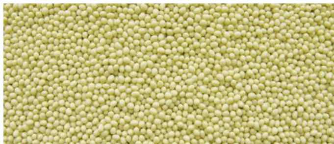
Obr.3 Jowatherm tavné lepidlo vo forme granúl, použité na príprave vzorkou v BP
