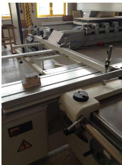
Obr.31, 32 Kotúčová deliaca píla s predrezom v dielni Mendelovej univerzity
