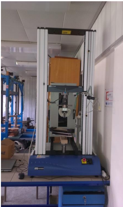
Obr. 22 Trhací stroj INSTRON 3365
