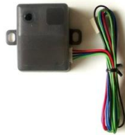
Obr. č. 7 - otřesový detektor, převzato a upraveno z [13]
