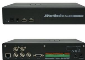
Obr. č. 47 - záznamové zařízení EB3004 MET SATA, převzato a upraveno z [39]
