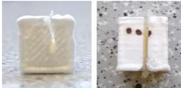
Obr. 37: Ukážka zhotoveného vrubu na 3D tlačenej vzorke v tvare kocky pripravenej z transparentného PLA filamentu, saturovanej pri teplote 25 °C a tlaku 5 MPa po dobu 72 h a penenej 60 s pri 130 °C
