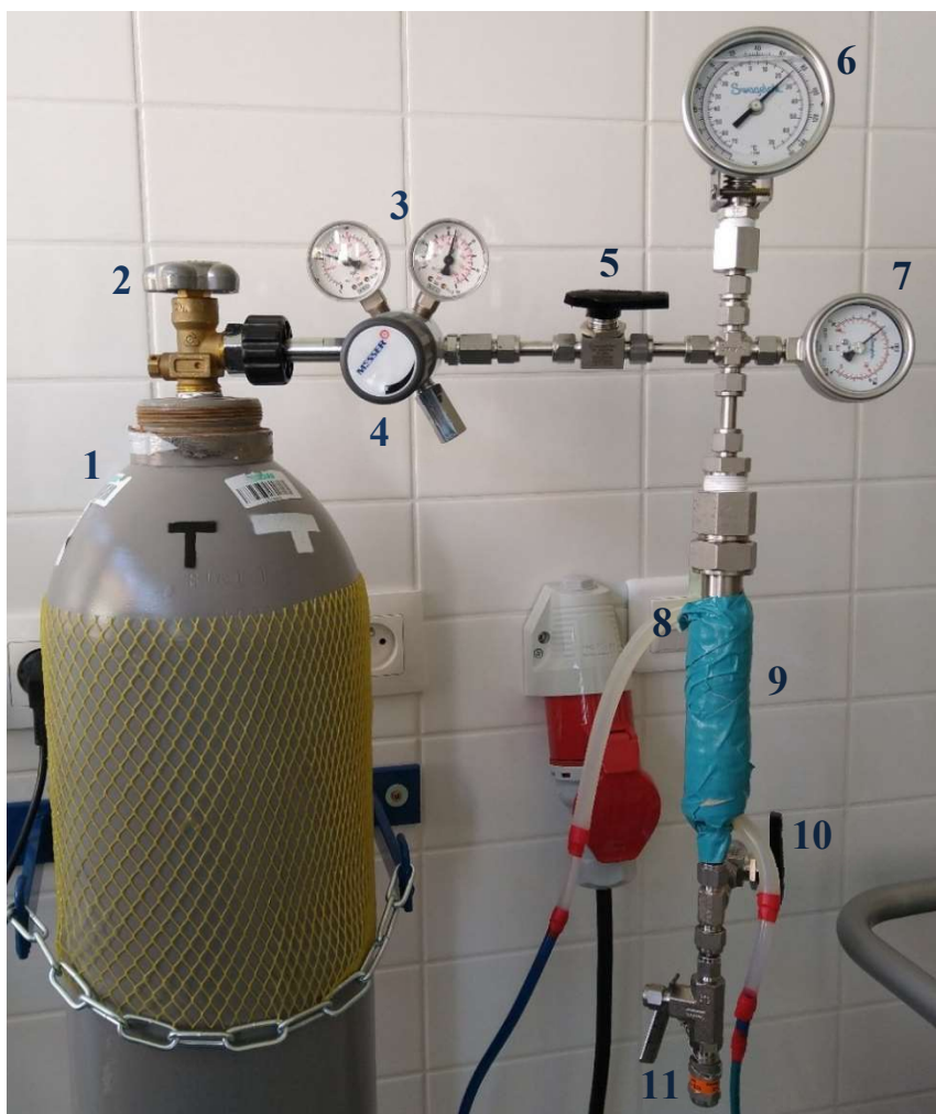
Obr. 28: Aparatúra na saturáciu vzoriek: 1) tlaková bomba s CO 2 , 2) hlavný ventil, 3) manometre redukčného ventilu, 4) redukčný ventil, 5) uzatvárací ventil, 6) teplomer, 7) manometer, 8) chladiace hadičky napojené na tepelnú komoru, 9) komora so vzorkami, 10) dekompresný ventil, 11) poistný ventil
