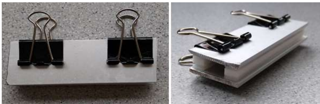
Obr. 29: Forma na penenie vzoriek v tvare trámiku v silikónovom oleji
