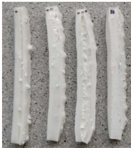
Obr. 32: 3D tlačné vzorky trámikov, pripravené z naturálneho PLA filamentu, saturované v CO 2 pri teplote 5 °C a tlaku 5 MPa po dobu 72 h a penené 60 s v silikónovom oleji pri teplote 70–130 °C s krokom 20 °C (zľava)
