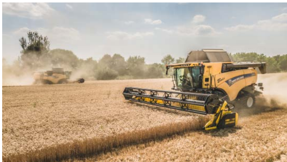
Obrázek 3 – Soudobé sklízecí mlátičky při sklizni porostu pšenice ozimé s tradičními adaptéry pro přímou sklizeň https://www.bisooriginal.cz/vsechny-clanky/prvni-dojmy-z-biso-vx-cropranger-vx850-tll-v-kombinaci-s-novym-new-holland-cx-8-80/
