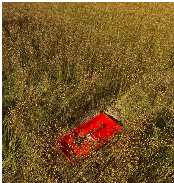
Obrázek 24 - Speciální vanička využitá pro měření ztrát na sklizňovém adaptéru
