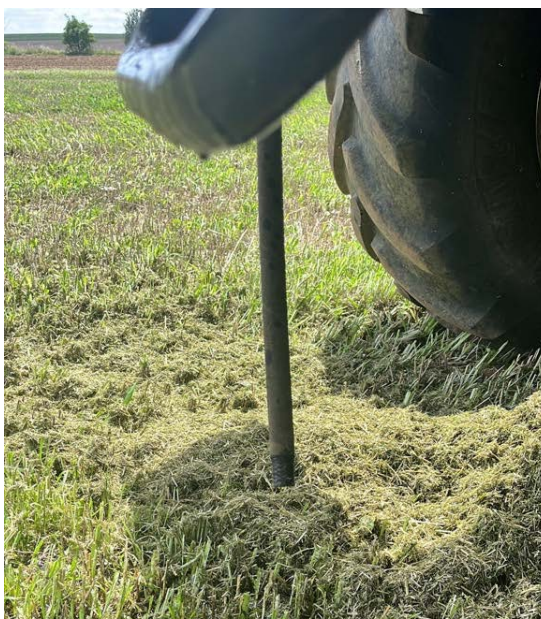
Obrázek 22 - Poškozené hydraulické vedení a rozdrčená zelená sklízená hmota
