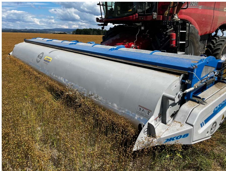
Obrázek 16 - Deflektorový kryt a ovládací přímočaré hydromotory
