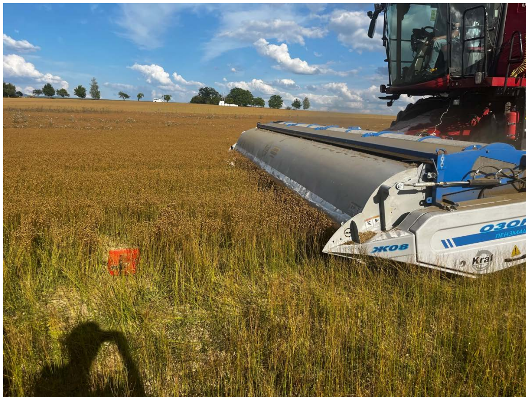
Obrázek 21 - Sběrná vanička umístěná v linii sklízecí mlátičky při práci
