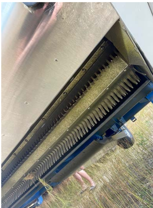
Obrázek 25 - Prsty bubnu vyčesávacího adaptéru s vrstvou usazenin
