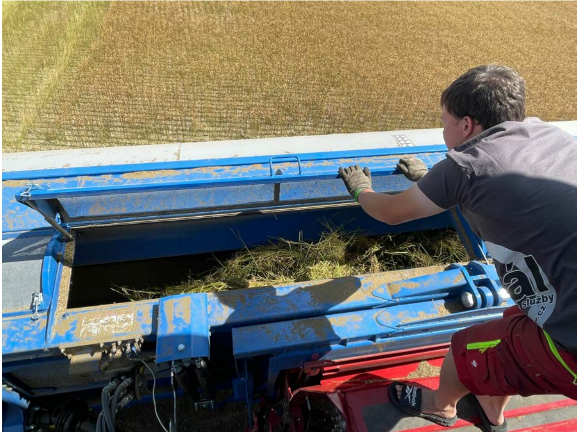
Obrázek 28 - Odstraňování namotané hmoty z průběžného dopravníku vyčesávacího adaptéru
