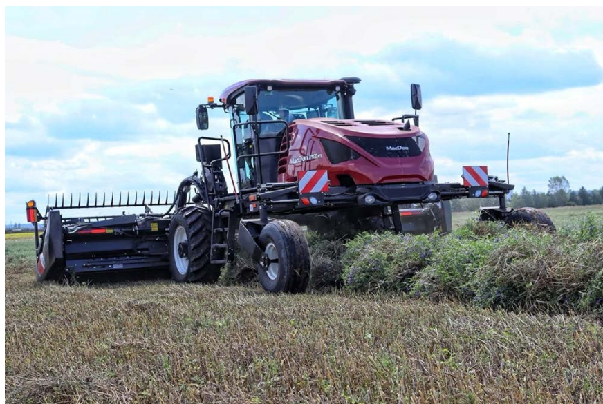
Obrázek 12 – Stroj Mac Don M1170 NT5 při řádkování porostu pro dvoufázovou sklizeň
