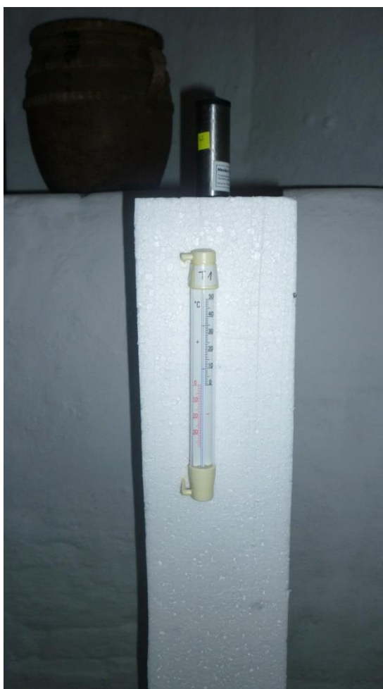
Obr. 18. – Způsob umístění teploměrů a dataloggerů.
