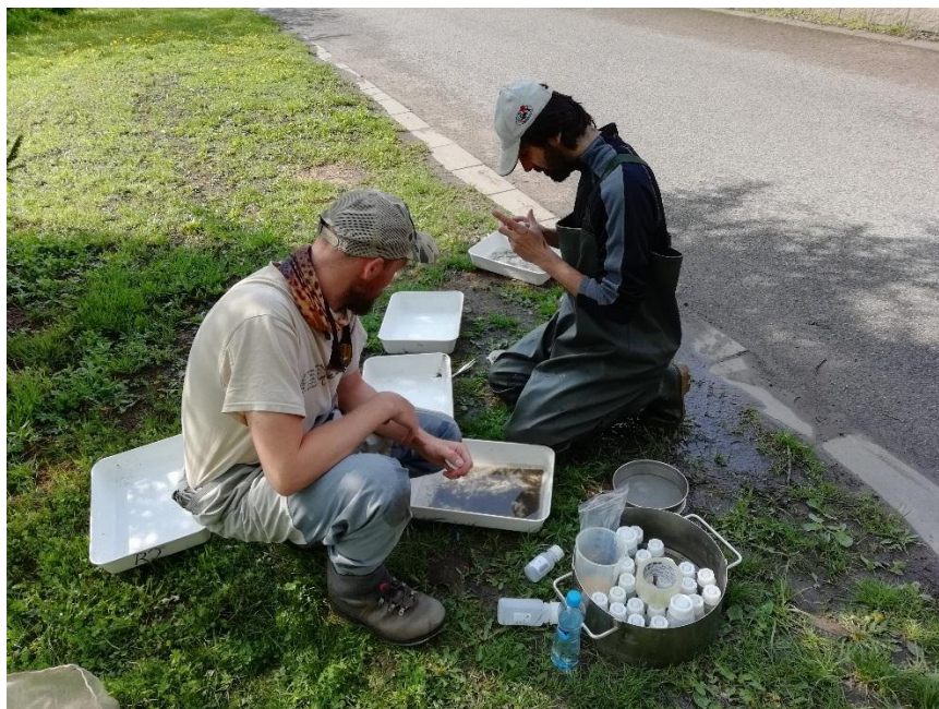
Obr. č. 33: Přebírání vzorků bentosu od detritu a jiného materiálu.
