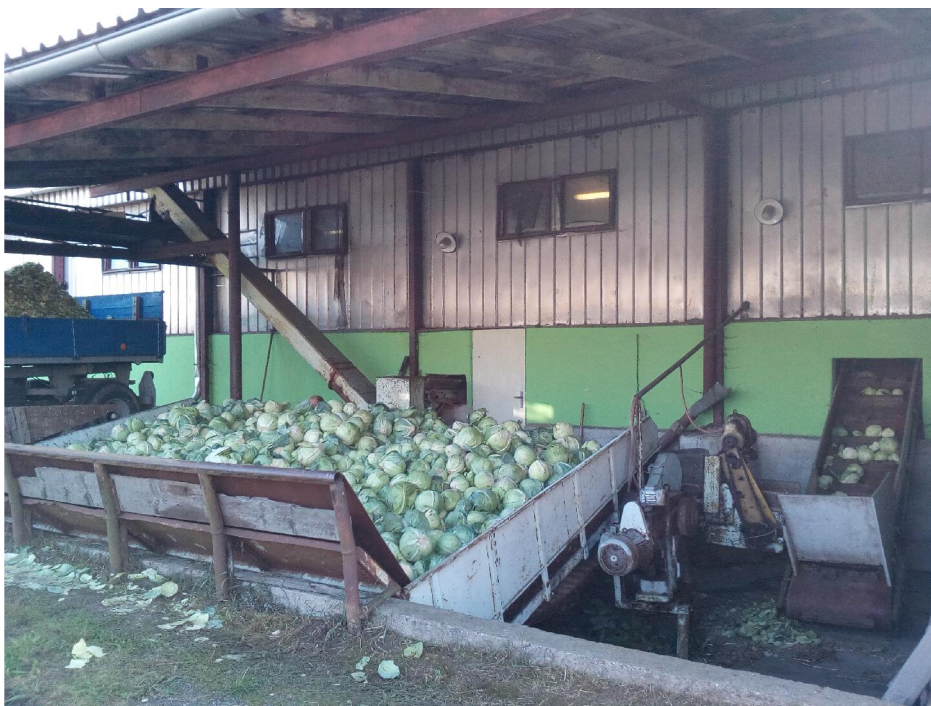
Obr. č. 2: Prostor ke sklápění zelných hlávek a dopravníkový pás (Foto: KOSTKOVÁ, 2018)
