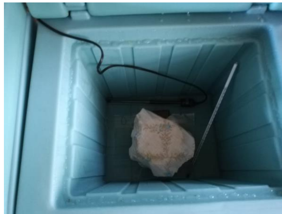
Obrázek 13 Pohled na speciální termobox, ve kterém byla teplota upravována za pomoci akvarijního topení a přilévání vroucí vody (30 °C) (archiv autora).
