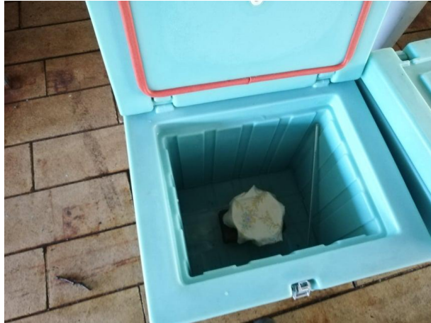
Obrázek 12 Pohled na speciální termobox, který byl temperován pomocí šupinkového ledu (5 °C) (archiv autora).
