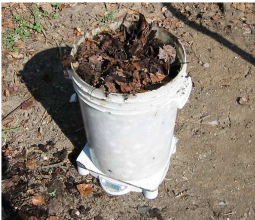
Obr. 10: Váha na měření objemové hmotnosti [foto autor]
