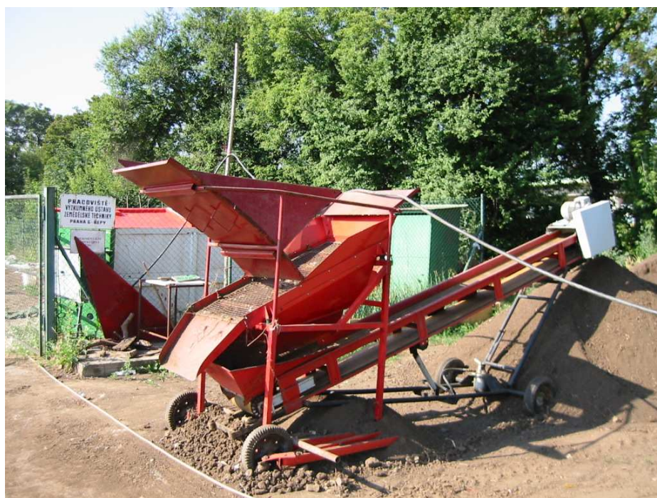
Obr. 14: Vibrační rovinné síto VSD 01 ve spojení s pásovým dopravníkem RM 9-019 [foto autor]
