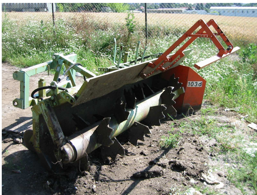
Obr. 12: Připojitelný překopávač kompostu 250 H [foto autor]
