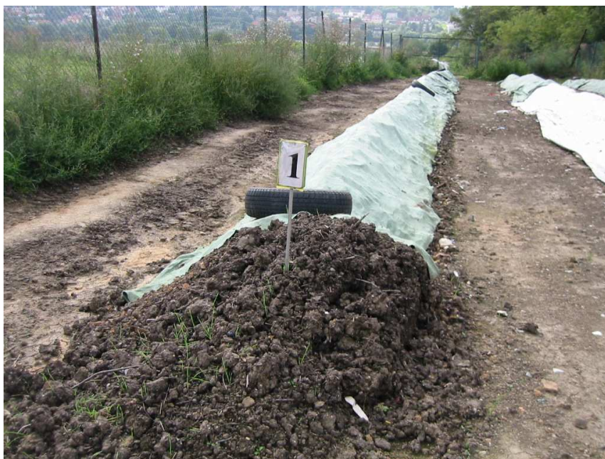
Obr. 16: Plachty na přikrývání pásových hromad kompostu [foto autor]
