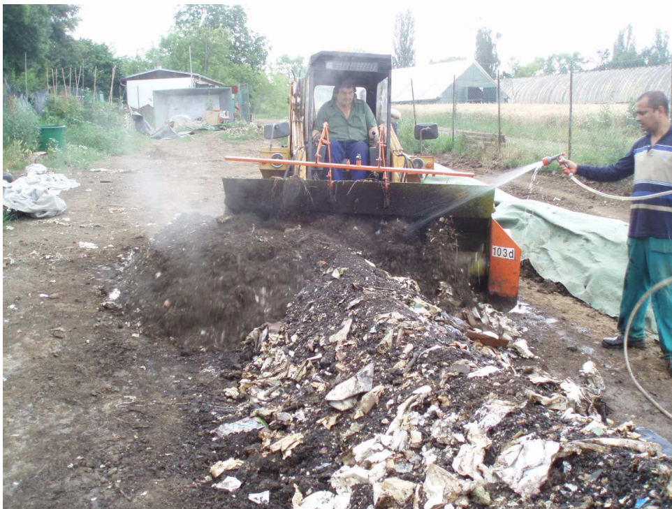
Obr. 13: Souprava - čelní nakladač UNC 060 s připojeným překopávačem 250 H [foto autor]
