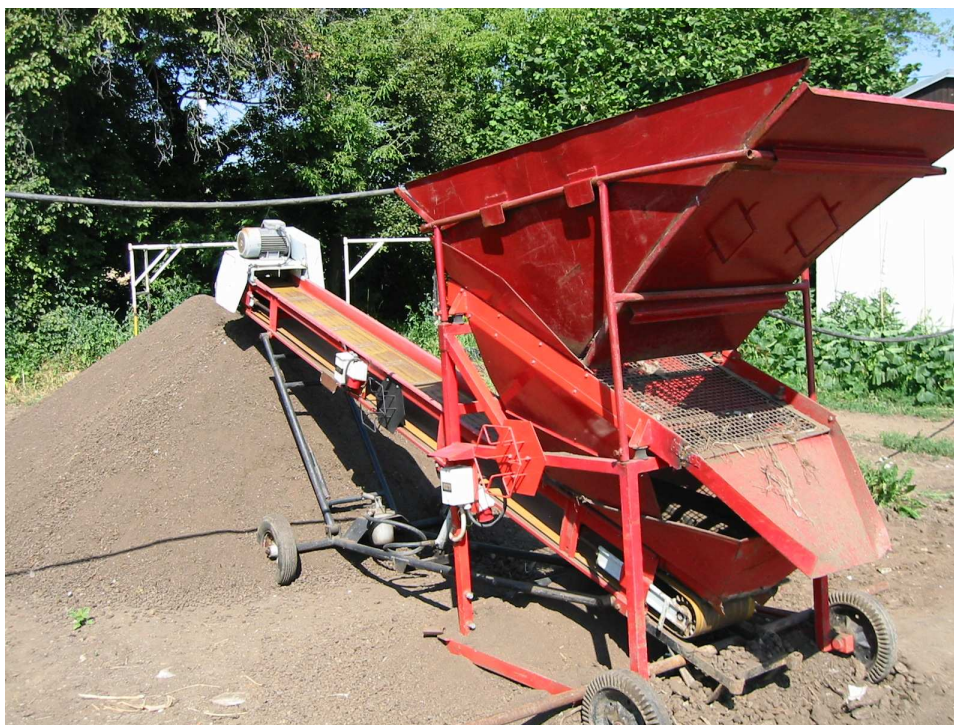
Obr. 15 : Mobilní pásový dopravník RM 9-019 [foto autor]
