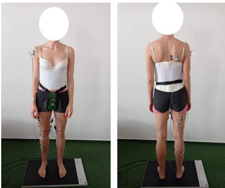
Obrázek 6 Výchozí poloha probanda s nasazeným bederním pásem zepředu (vlevo) a zezadu (vpravo)
