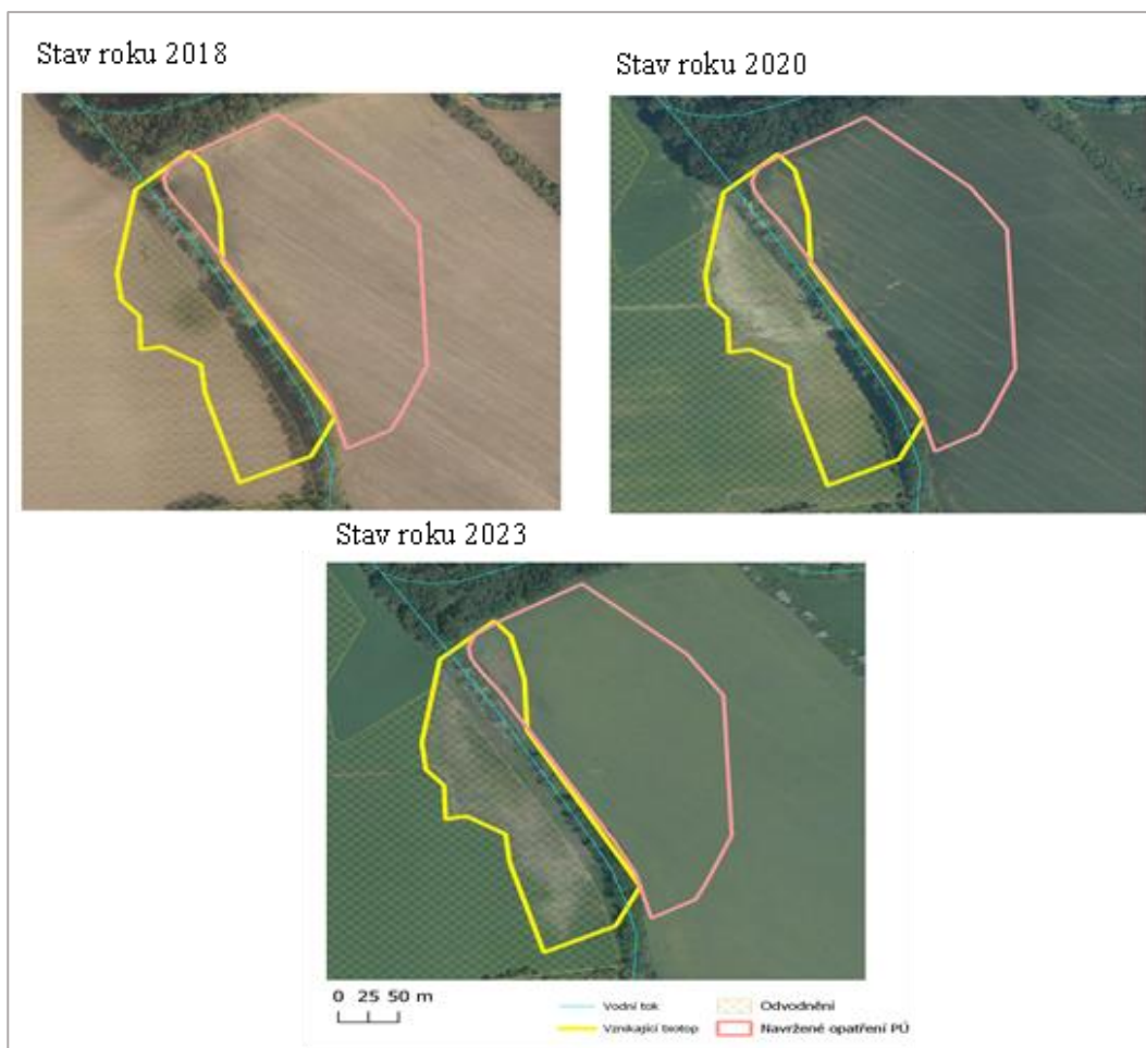
Obrázek 26: Lokalita vykazující problém s retencí vody a nefunkční systém odvodnění v obci Bánov na podkladě ortofotosnímků v letech 2018, 2020 a 2023 Zdroj: SPÚ (2023), ČÚZK (2023f), vlastní zpracování
