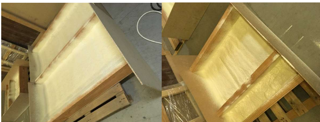
Obr. č. 22 Vzorky s nánosem cca 3 cm pěny s uzavřenou strukturou buněk
