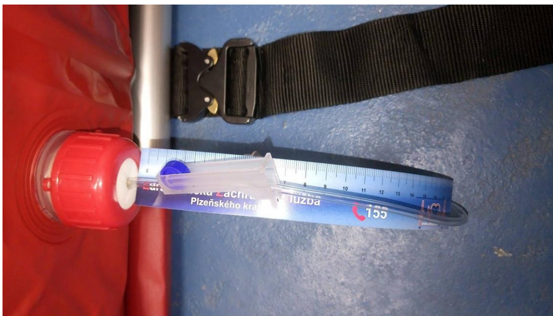
Obrázek 3 Infuzní set skrz průchodku – výchozí stav
