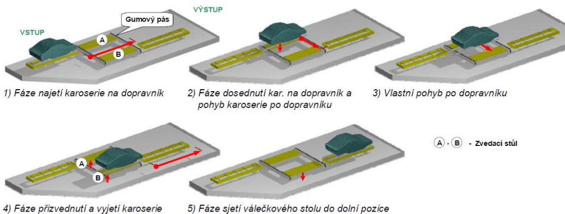
Obr. 5 – Příčně přesuvný stůl [3]
