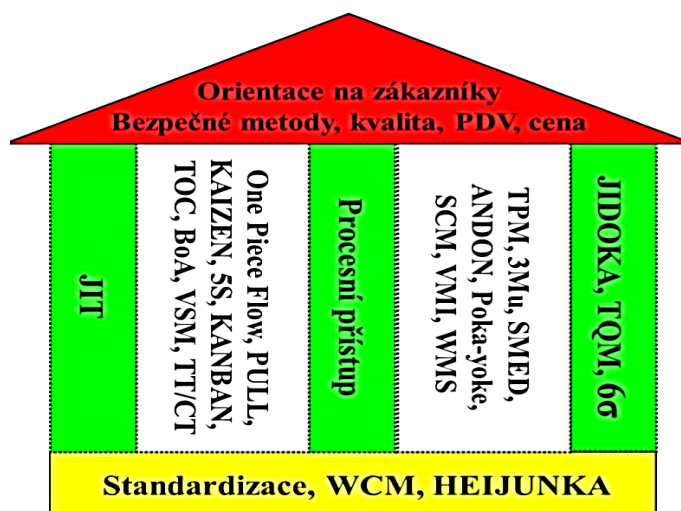
Obr. 3 Schéma štíhlé výroby s pilíři a metodami
