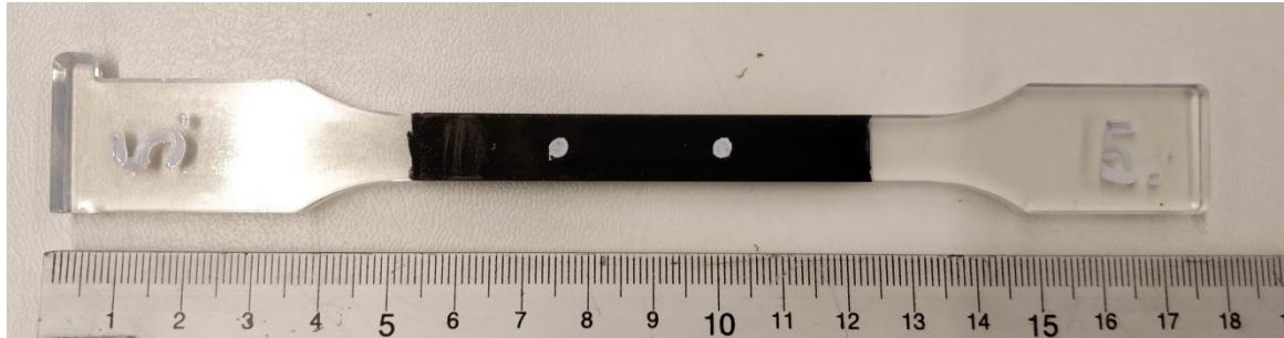
Obrázek 4.5: Vzorek opatřený vizuálními prvky pro zkoušku tahem na zařízení INSTRON 5967.
