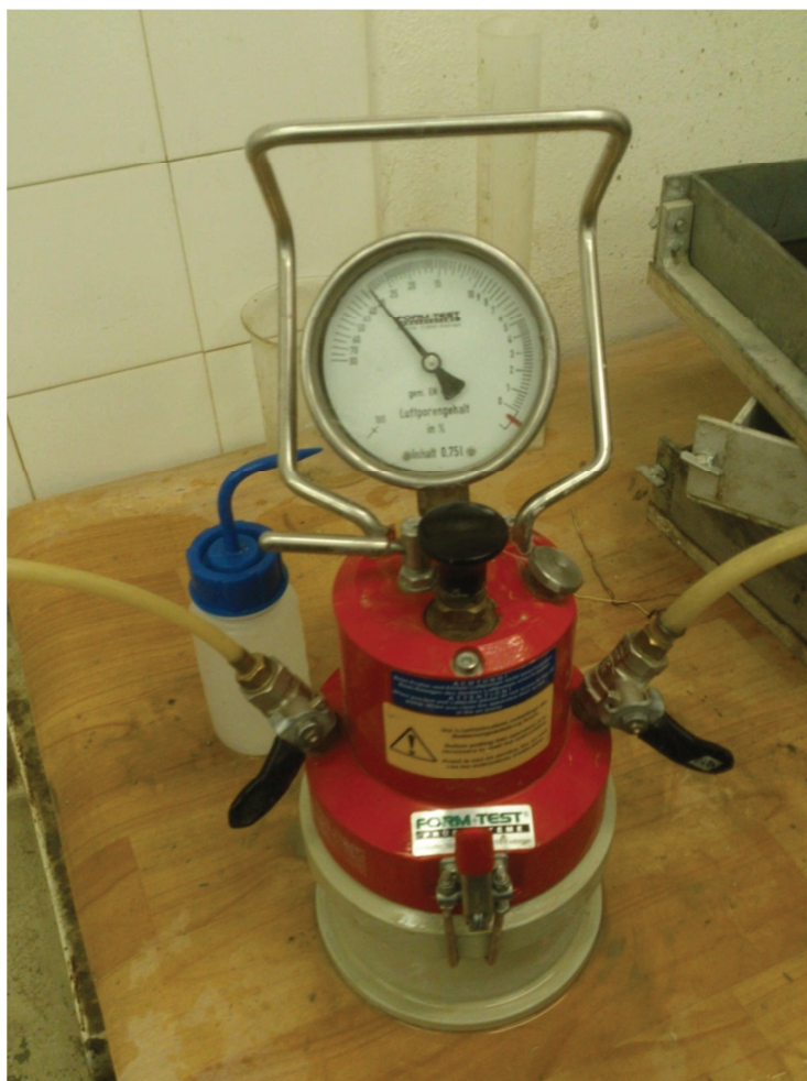
Obr. 13 Měření obsahu vzduchu v čerstvé maltě
