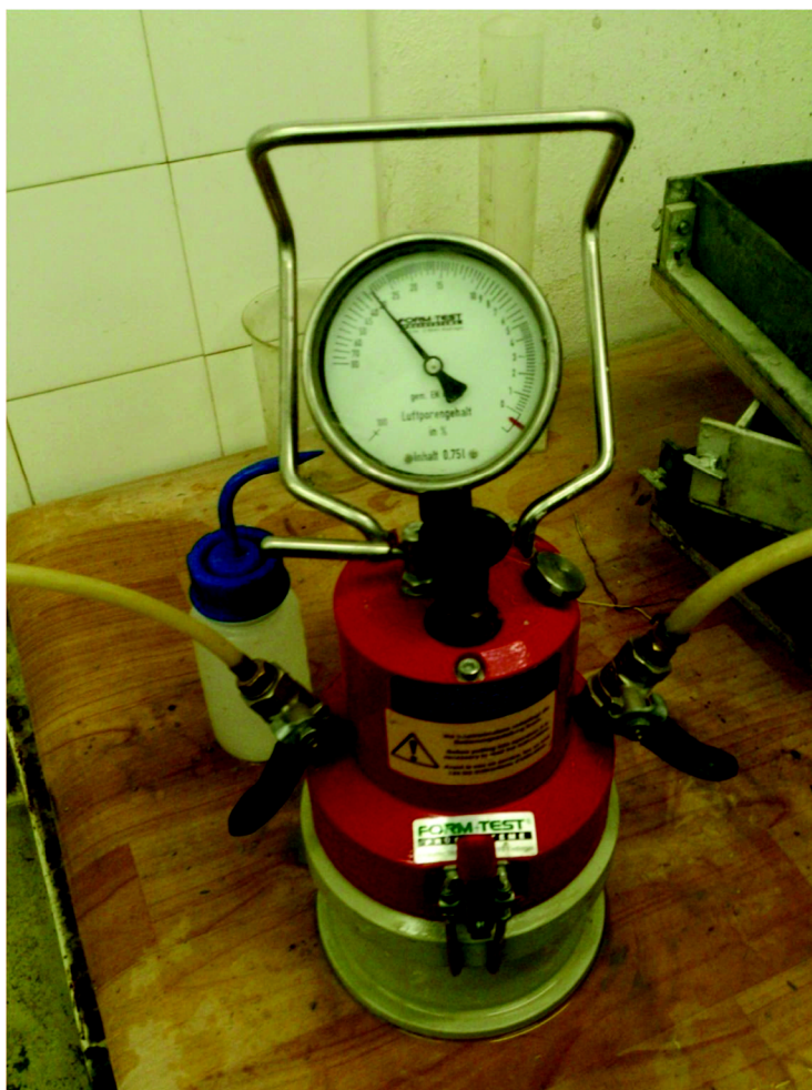
Obr. 13 Měření obsahu vzduchu v čerstvé maltě
