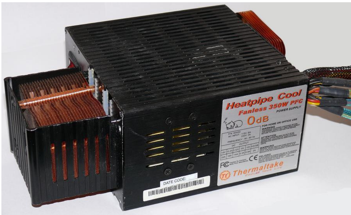
Obr. 35. Thermaltake W0050 (350W fanless zdroj)
