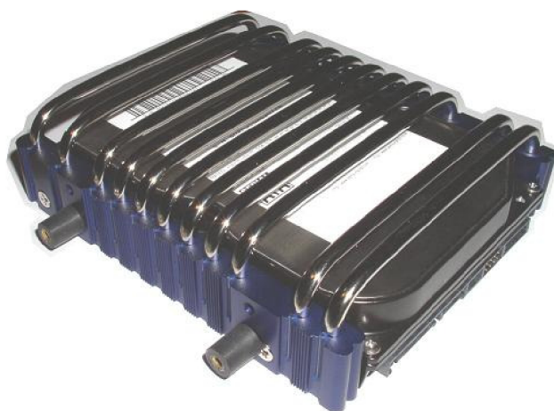
Obr. 15. Antivibrační držák disku, a) Sharkoon HDD VIBE-FIXER 3 [24], b) Zalman ZM-2HC2 instalovaný na pevný disk [13].
