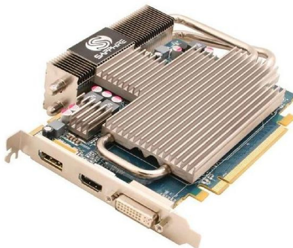
Obr. 10. Pasivně chlazená grafická karta Sapphire ATI Rad Ultimate HD5670 [24]
