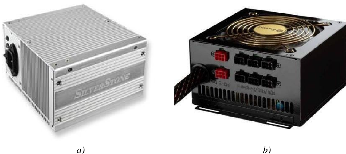
Obr. 8. Zdroj a) s pasivním chlazením [21], b) s možností odpojení nepotřebné kabeláže [18]
