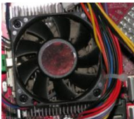
Obr. 14. Aktivní chladič CPU zanesený prachem, a) celkový pohled, b) pohled pod ventilátor
