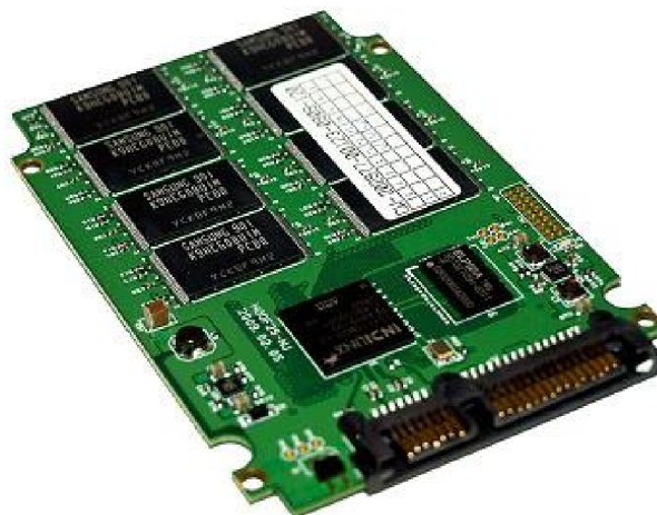
Obr. 18. Vnitřní uspořádání SSD disku [16]
