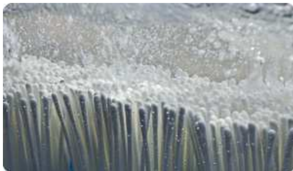
Obr. 10.6 Pohled na membránová vlákna v UF PURON MBR Series od firmy Koch membrane systems [9]
