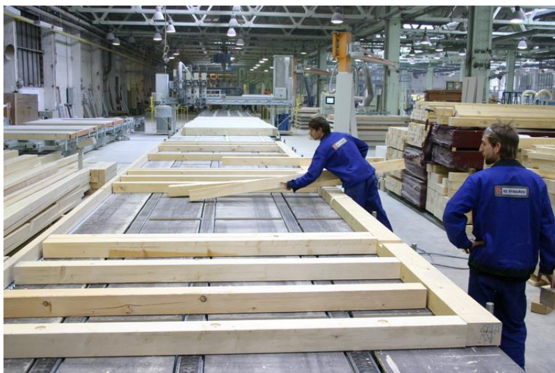
Obr. 2 - Výroba nosného rámu z dřevěných hranolů (RD Rýmařov)
