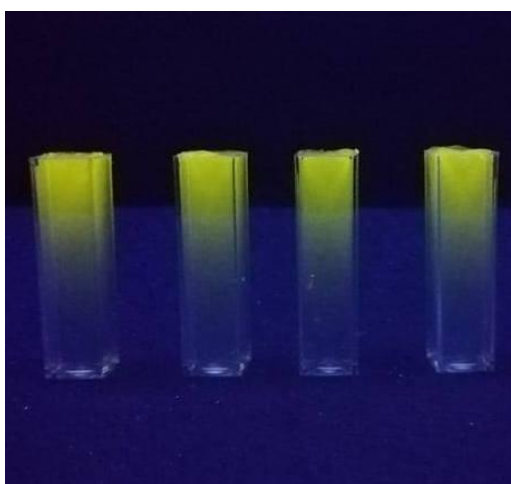
Obr. 35: Vizuálna charakterizácia PVA hydrogélův po ukončení experimentu; naľavo je PVA hydrogél bez prídavku polyelektrolytu; smerom doprava sa zvyšuje koncentrácia pridávaného Alg
