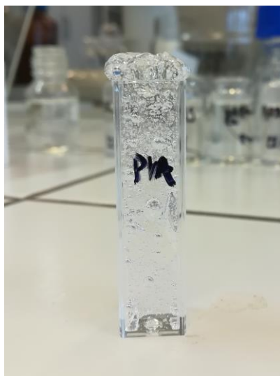
Obr. 14: PVA gél po prevedení do kyvety – prítomnosť vzduchových bublín
