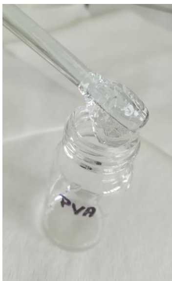
Obr. 19: Prichytávanie PVA gélu na sklenenú tyčinku počas prípravy
