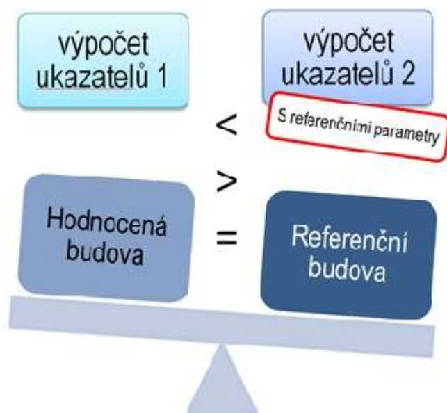
Obr. 3 Princip hodnocení ENB [6]
