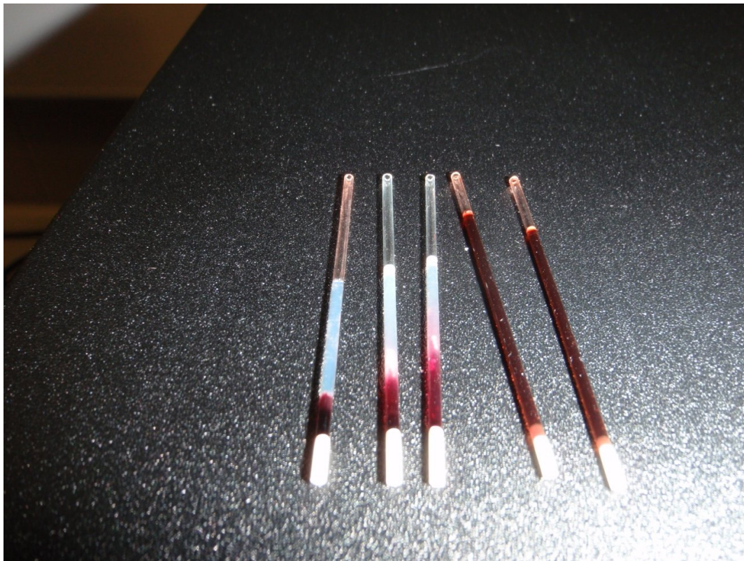
Obr. 4 Odstředěné (první tři kapiláry zleva) a neodstředěné hematokritové kapiláry, v některých případech byla krev hemolytická a po odstředění nedošlo k vytvoření jasně ohraničených zón (třetí kapilára zleva) (foto V. Bulíček)
