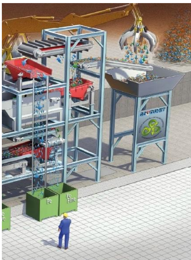
Obr. 11 Příklad využití magnetické separace v průmyslovém odvětví (zpracování odpadu)
