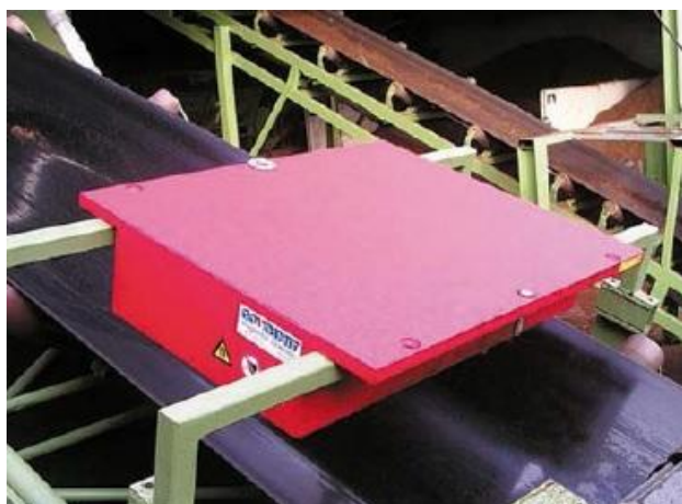
Obr. 12 Magnetický blok nad pásovým dopravníkem
