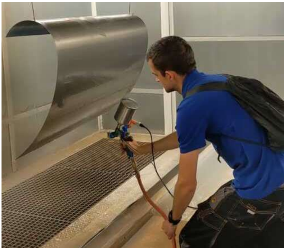
Obr. 8: Učení robota lakování pomocí napodobování pohybu [53]
