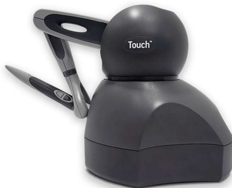
Obr. 13: Haptické zařízení Touch 3D Systems [57]
