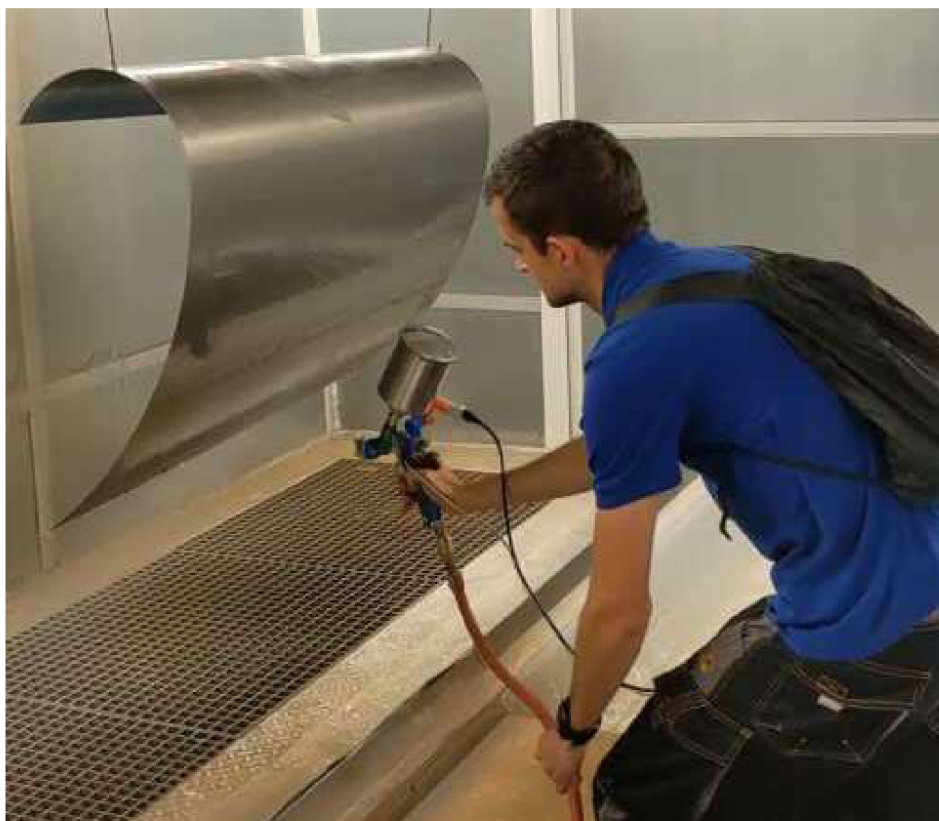
Obr. 8: Učení robota lakování pomocí napodobování pohybu [53]
