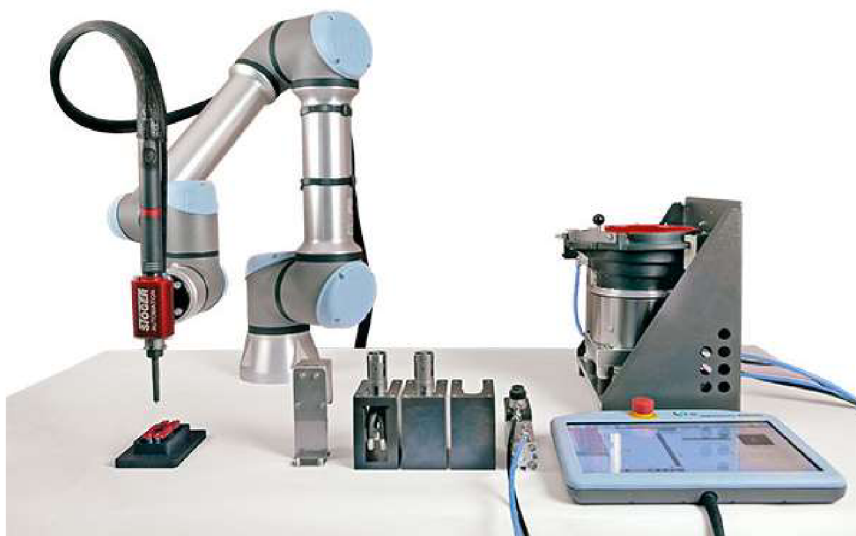
Obr. 10: UR+ Automatický šroubovací systém SPATZ [55]
