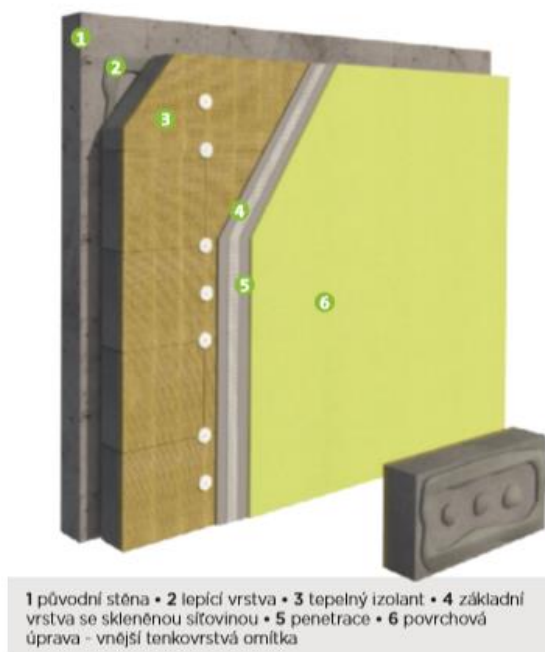
Obr. 2 Skladba kontaktního zateplovacího systému
