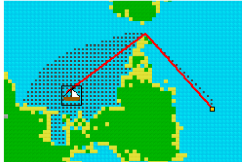
Obrázek 14: Ukázka grafického znázornění fungování algoritmu A*. Prohledávaná pole jsou označena šedou barvou, pole nalezené cesty jsou vyznačena barvou červenou.
