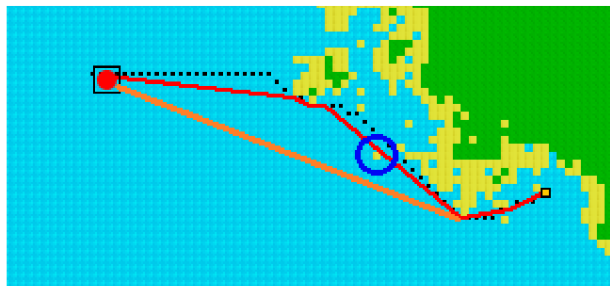
Obrázek 15: Nalezená cesta (červeně) se bez dopředného prohledávání odklání od přímější cesty (oranžově). Modrý kroužek označuje bod způsobující tento odklon.
