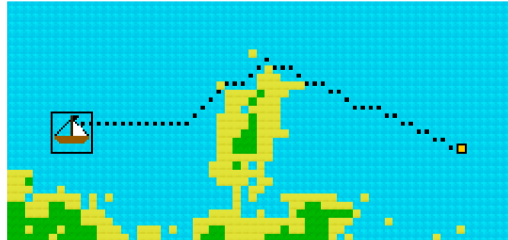
Obrázek 11: Použití heuristiky Eukleidovská vzdálenost zlepšit tvar cesty při přiblížení se k cílovému (oranžovému) bodu. Vlevo od překážky vypadá cesta stále nerealisticky.
