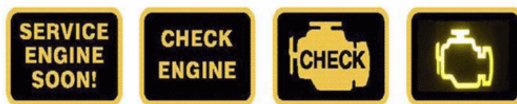
Obr. 34: Kontrolky OBD neboli MI (Malfunction Indicator) umístěné na přístrojové desce [57]
