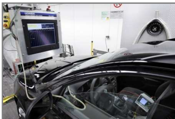
Obr. 44: Laboratorní měření spotřeby paliva na válcové brzdě, německým autoklubem ADAC [73]
