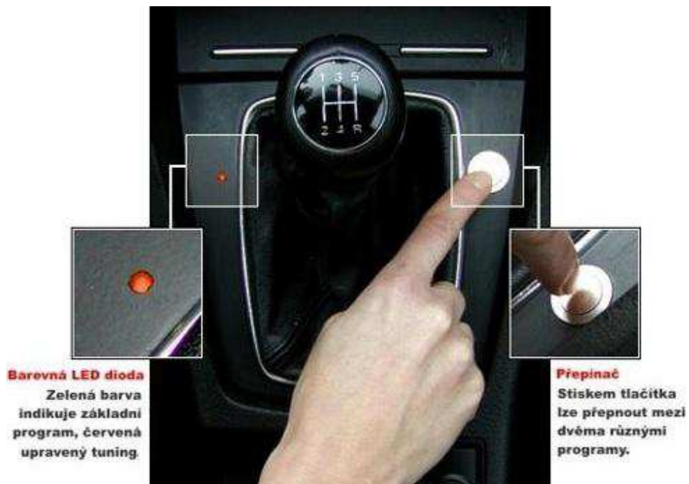
Obr. 7: Přepínač režimů a LED diofa pro indikaci aktuálně nastaveného programu [78]
