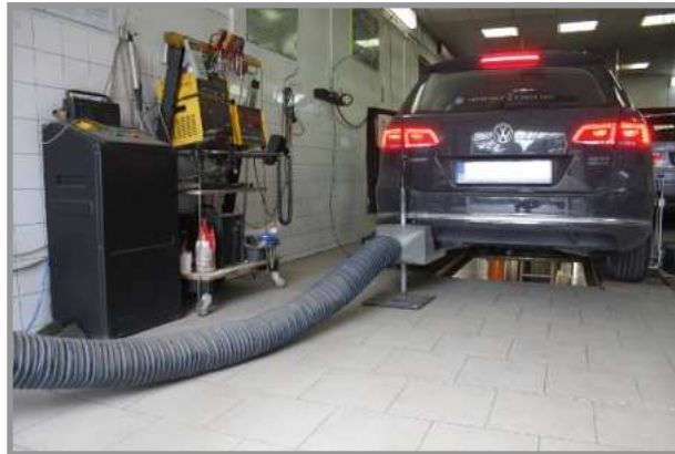
Obr. 43: Měření emisí výfukových plynů [71]
