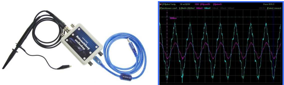
Obr. 36 a 37: Automobilový osciloskop a zobrazení jeho signálu v reálném čase [62, 61]
