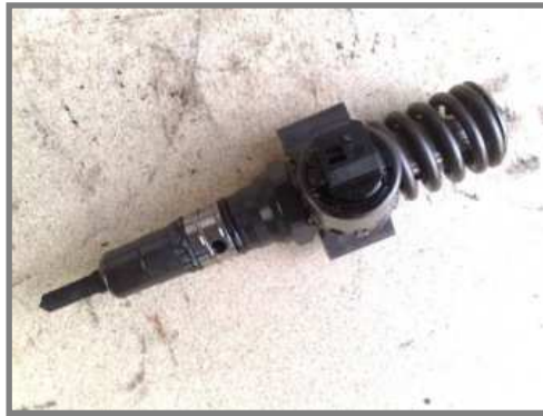
Obr. 48: Vstříkovací tryska z VW Bora 1.9 TDI / 74 kW
