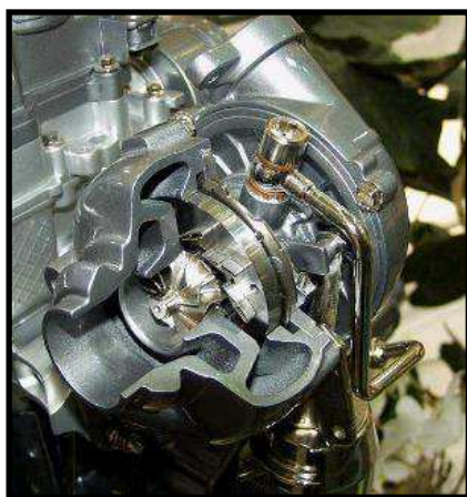
Obr. 23 a 24: Turbo s proměnnou geometrií lopatek VGT a jeho průřez [45]
