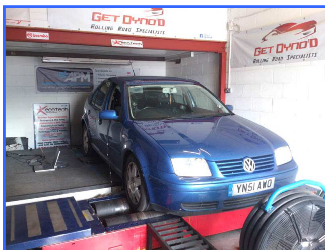
Obr. 50: Volkswagen Bora 1.9 TDI PD 74 kW / 101 PS na dynamometru (válcové brzdě)
