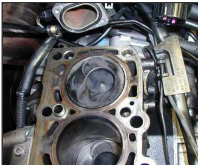
Obr. 45: Písty motoru poškozené příliš dlouhou délkou vstříku [75]
