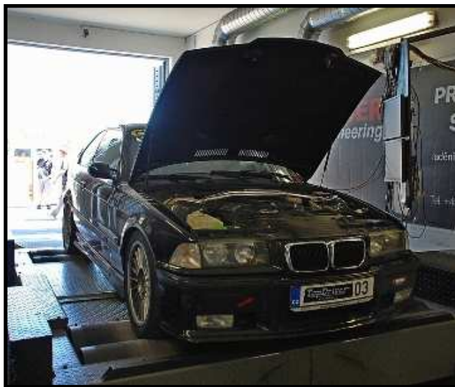
Obr. 41: Měření výkonu na válcovém dynamometru [70]
