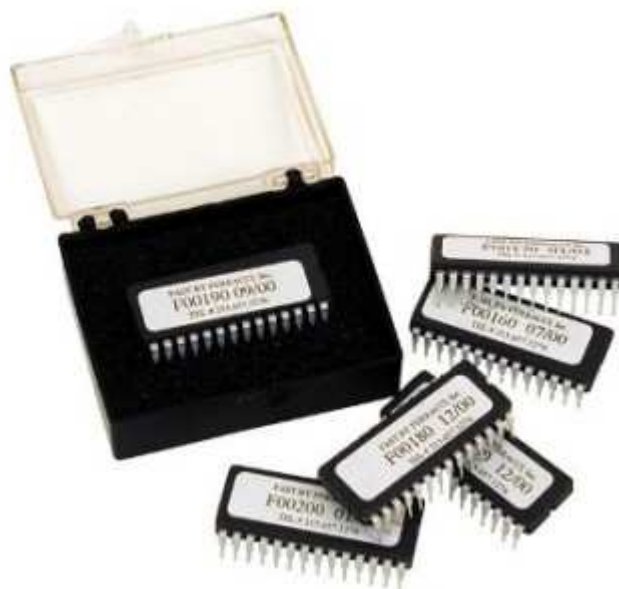
Obr. 2: Polovodičová paměť EPROM (chip) [16]
