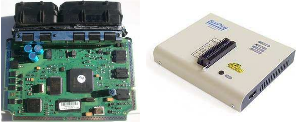
Obr. 27 a 28: ECU po odstranění krytu a programátor EPROM [49]
