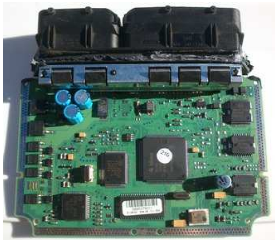
Obr. 49: Elektronická řídicí jednotka (ECU) BOSCH 038906019DL
