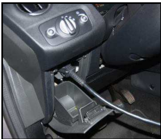
Obr. 4: Zapojení počítače do diagnostické zásuvky automobilu [21]
