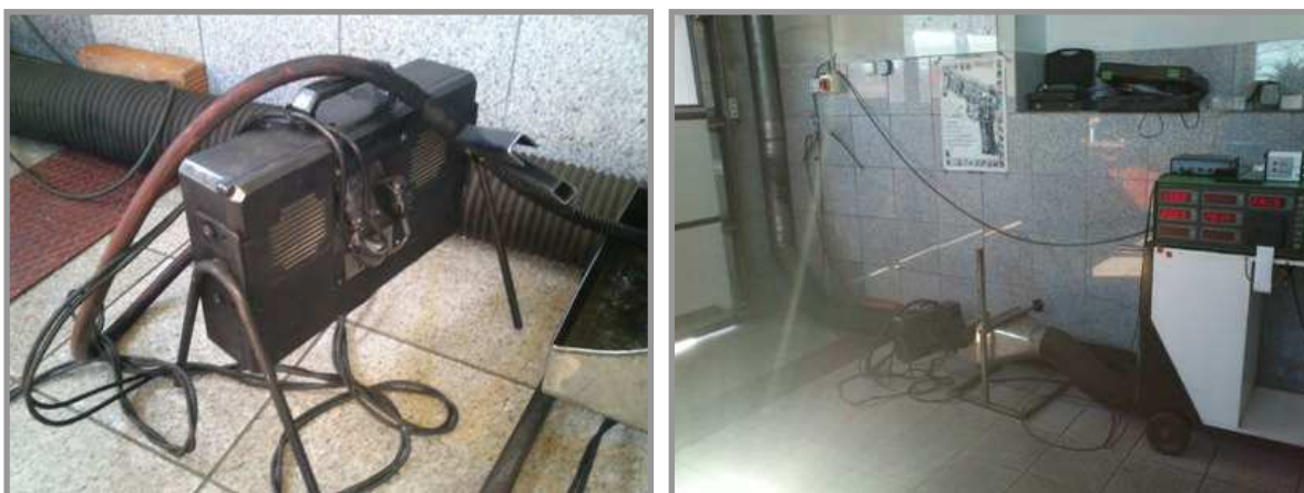
Obr. 59 a 60: Opacimetr AT 601 (vlevo) a emisní analyzátor AT 501 (včetně kouřoměru, vpravo)
