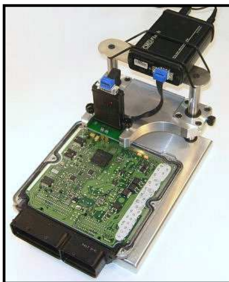
Obr. 10: Elektronická řídicí jednotka (ECU) [27]
