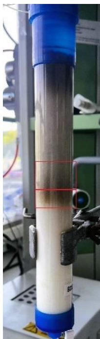
Obr. 13 Kolona naplněná iontoměničem High Q při eluci proteinů ze vzorku AR. Elučním pufrům byl 50 mM BIS-TRIS (pH 7,0) obsahující 2 M NaCl. Na koloně jsou okem patrné dvě rozdílně barevné frakce, spodní frakce 1 a horní frakce 2 (červeně označené).
