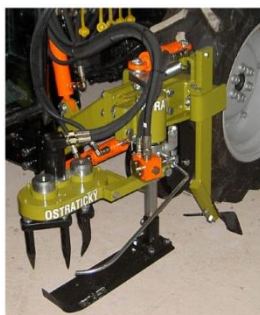
OBR č. 21: Výkyvné sekce mezinápravové s rotačním kypřičem a odorávací radlicí (zdroj: www.ostraticky.cz )
