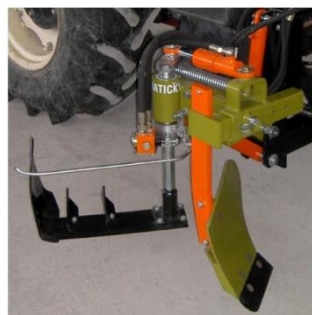
OBR č. 21: Výkyvné sekce mezinápravové s rotačním kypřičem a odorávací radlicí (zdroj: www.ostraticky.cz )
