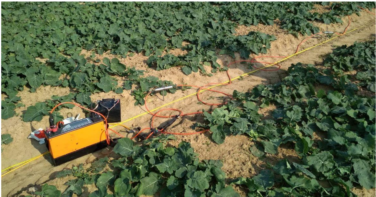
Obr. 14. Řídicí jednotka ARES při měření na lokalitě Kunín. Foto: Michal Šulc.
