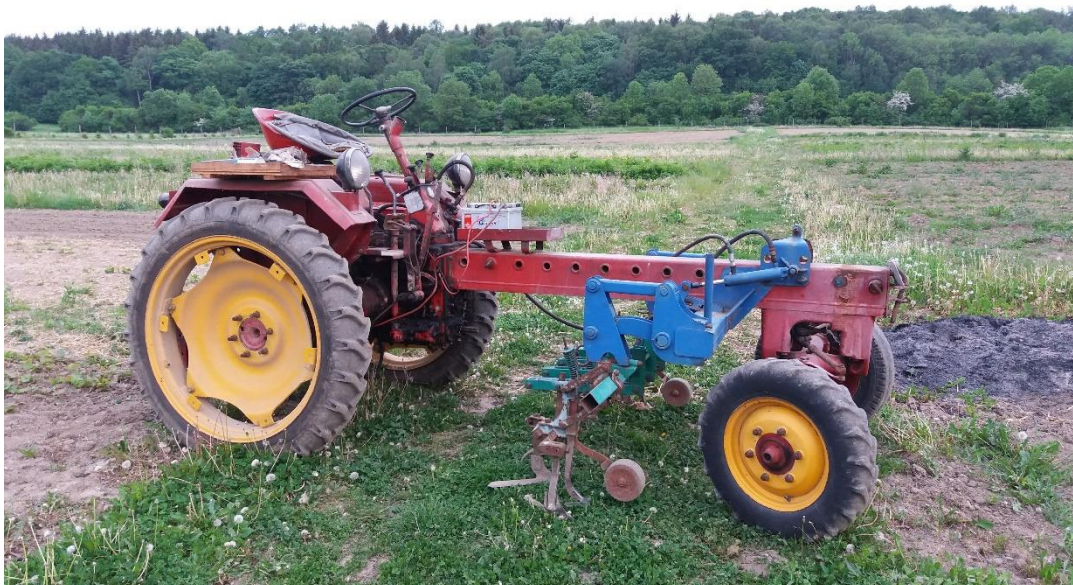
Fotografie č. 2: Nosič náradí RS09 s pasivním kypričem RATH
