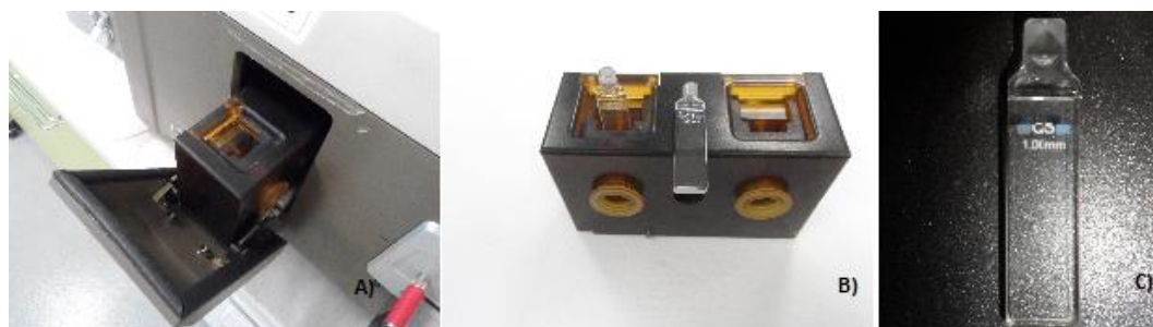
Obr. 16: Transmisní režim na FT-NIR Antaris: A) transmisní komora; B) kyvetový prostor; C) skleněná kyveta s optickou drahou paprsku 1 mm
