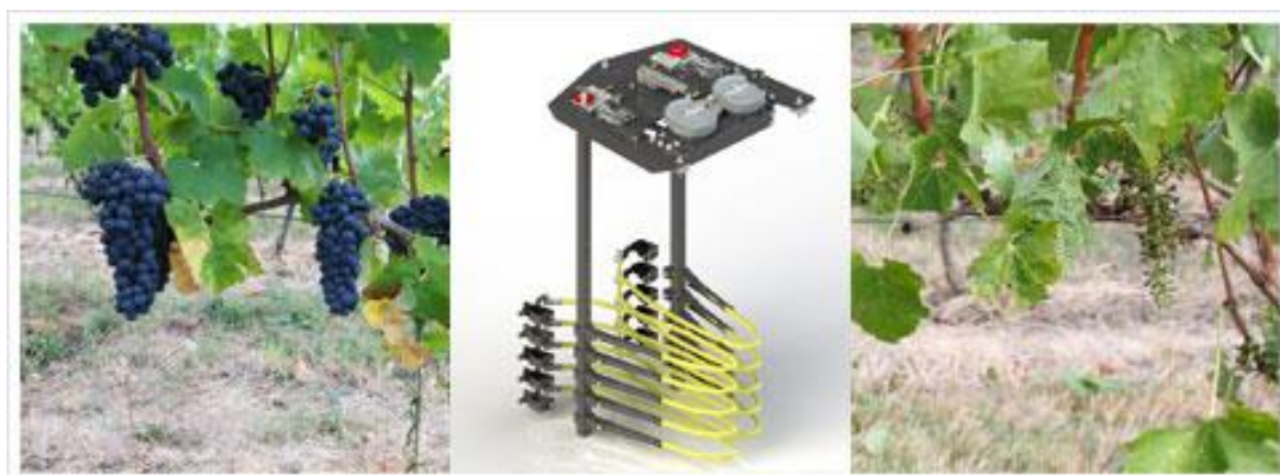
Obr. 5 setřásací pruty kapkovitého tvaru (Pellenc, 2014)
