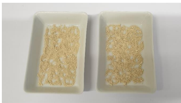
Obrázek 9 – Smíchané a rozemleté prekurzory před kalcinací.
