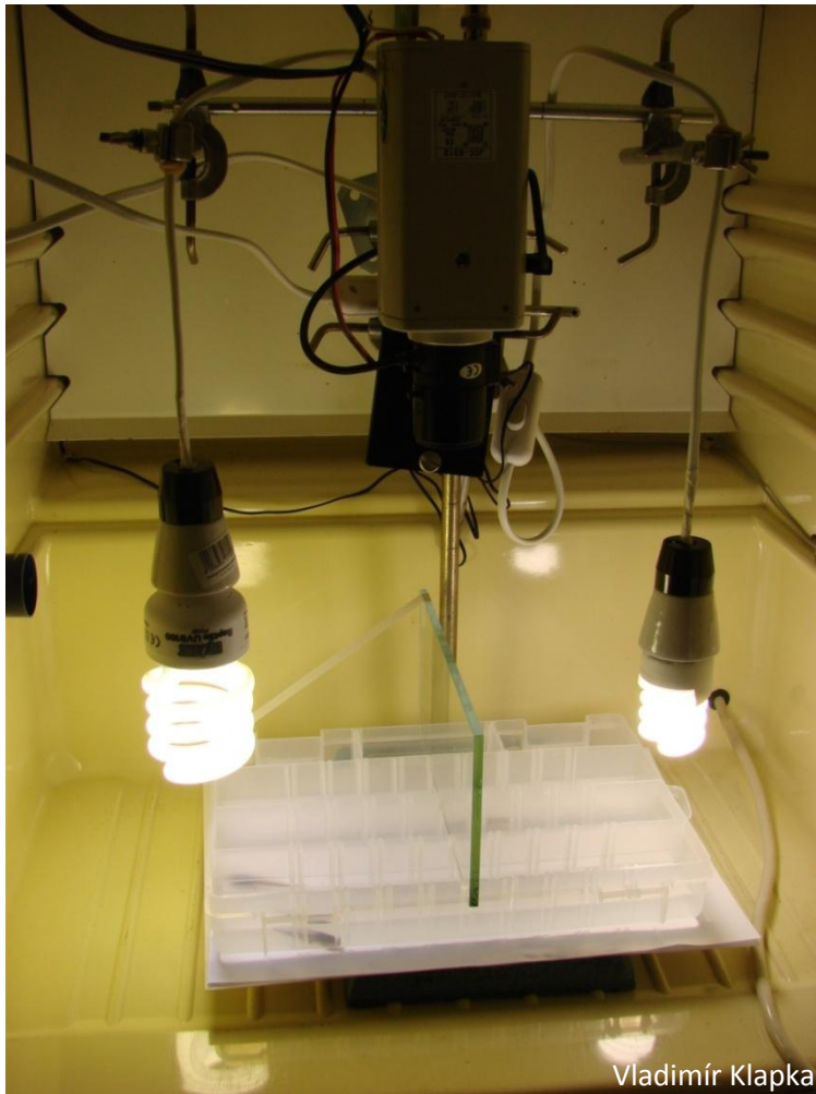
Foto 1: Uspořádání arén, kompaktních zářivek a kamery v klimatizovaném boxu.
