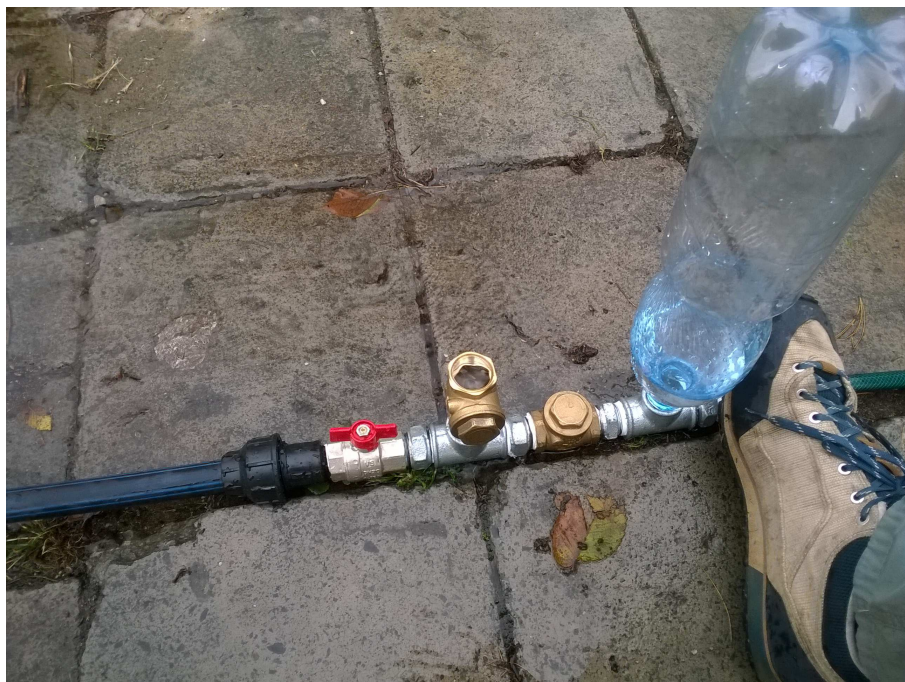
Obrázek 5.1: Použití PET láhve na místo tlakové nádoby
