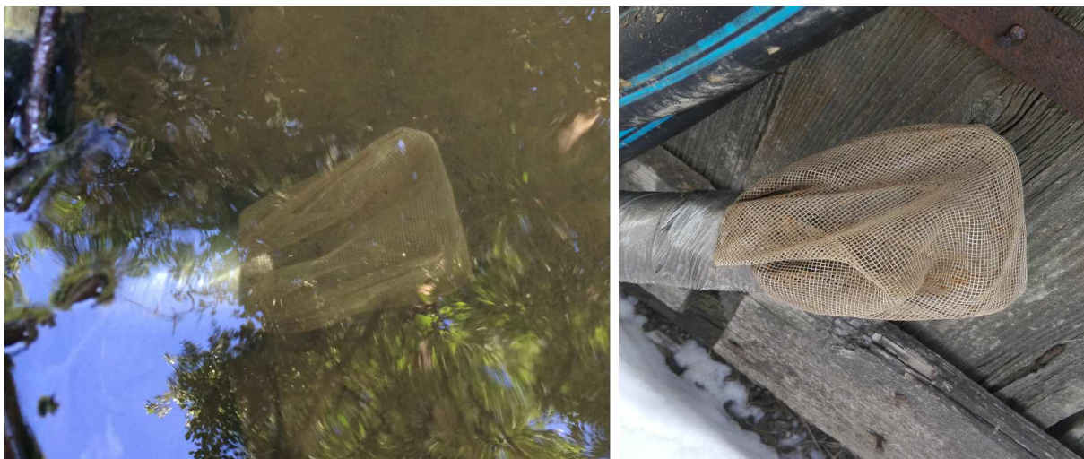
Obrázek 7.2: Zanesený filtr (vlevo) proti čistému filtru (vpravo)
