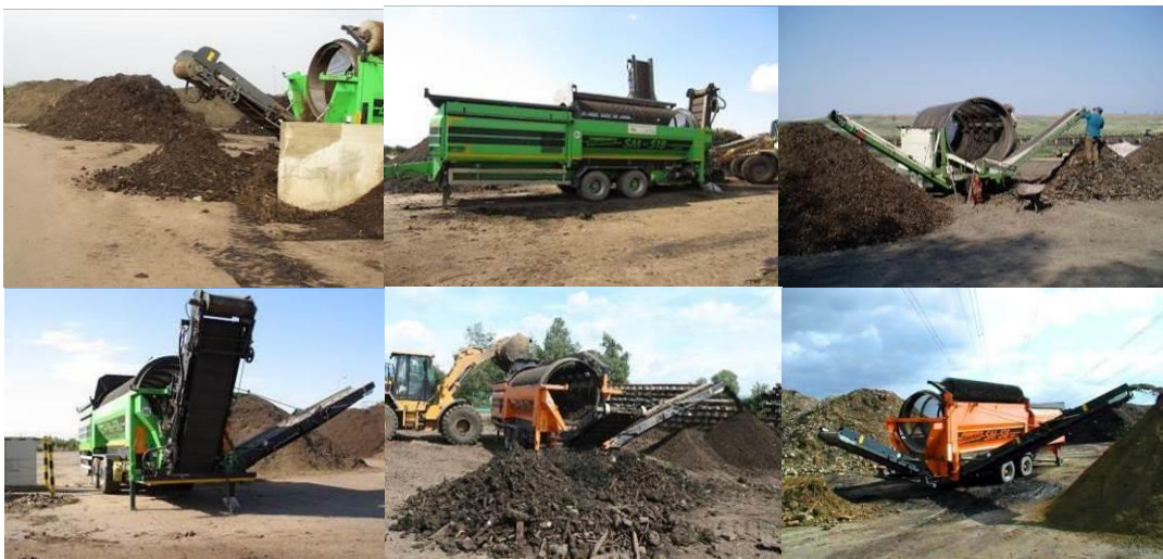
Obrázek 47 Třídění – bubnový třídič a nakladač (Zdroj: a, b, d - Karhánková, I., c - Řada L - bubnové třídiče PEZZOLATO, 2014, e – Trnavský, 2008, f - Rotačné triediče Doppstadt rady SM, 2014)
