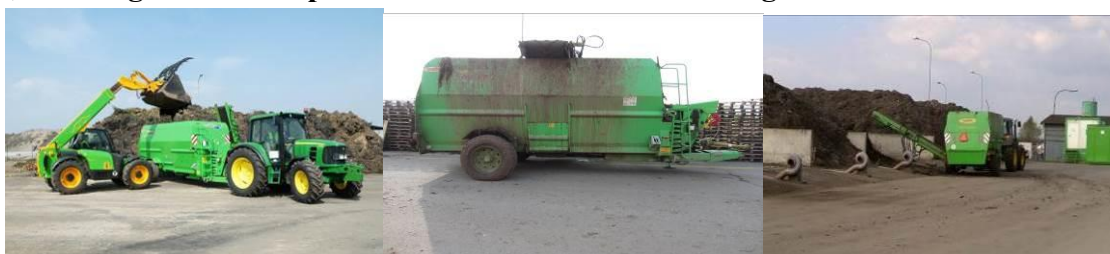
Obrázek 44 Homogenizace vstupních surovin – nakladač a homogenizér s traktorem (Zdroj: a - Homogenizace (míchání) kompostů, 2015, b, c - Karhánková, I.)
