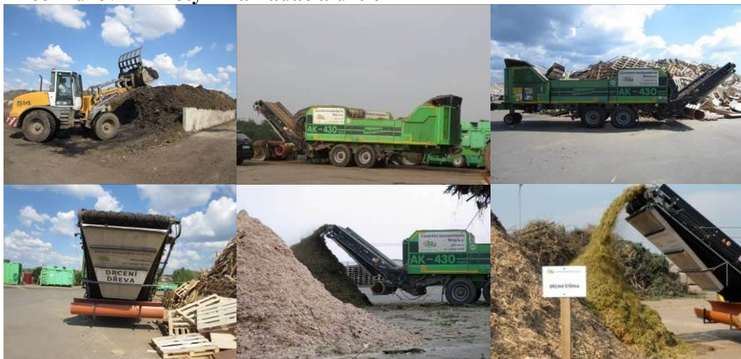
Obrázek 43 Drcení dřevní hmoty nakladač a drtič (Zdroj: a, b, c, d - Karhánková, I, e - Kašperová, 2013, f - Centrální kompostárna Brno recykluje dřevo, 2014)
