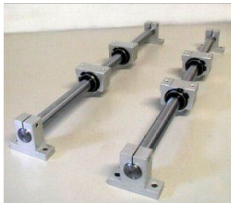
Obrázek 2.11: Ocelová vodící tyč [9]
