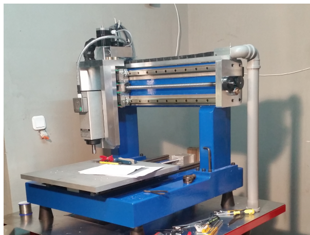
Obrázek 2.5: Homemade CNC s ocelovou konstrukcí [1]
