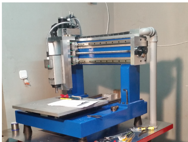
Obrázek 2.5: Homemade CNC s ocelovou konstrukcí [1]
