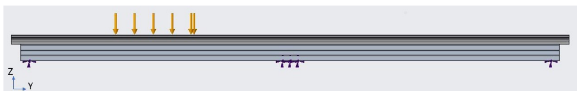
Obrázek 3.9: Okrajové podmínky sestavy Al profilu a lineárního vedení
