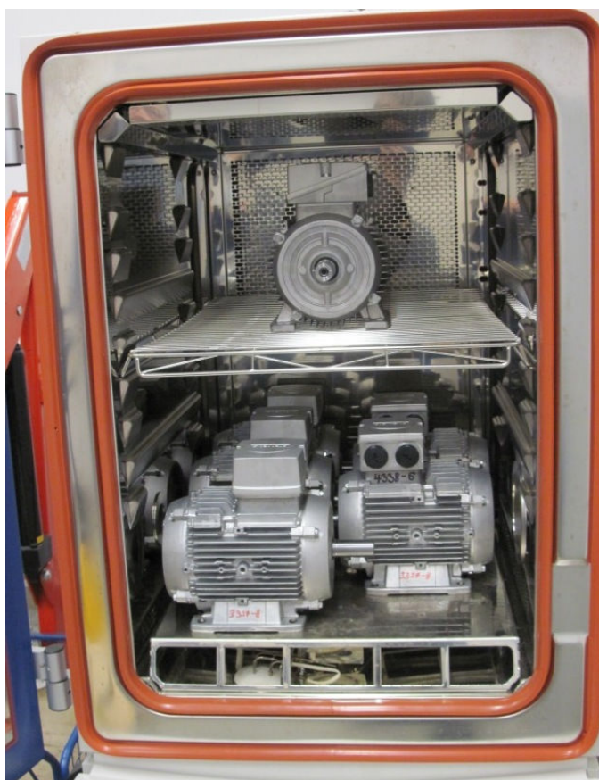
Obrázek 19 – motory umístěné v aplikačním prostoru klimatické komory WK3-340/70
