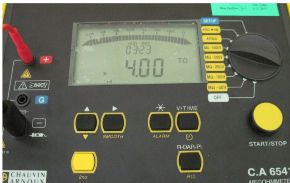
Obrázek 12 – indikace překročení rozsahu (naměřeno >4 T\Omega )
