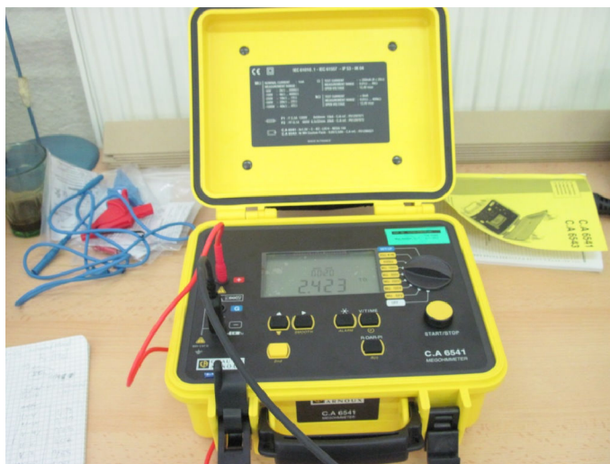
Obrázek 4 – měřič izolačního odporu C.A6541 (výrobce Chavin Arnoux)
