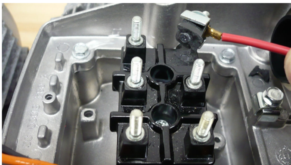
Obrázek 26 – odlomený kus bakelitové svorkové desky na jednom z motorů
