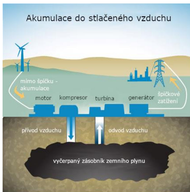
Obrázek 16 - Schématické znázornění akumulace do stlačeného vzduchu
