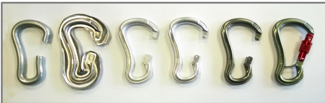
Obr. 2-10 Jednotlivé fáze výroby karabiny
