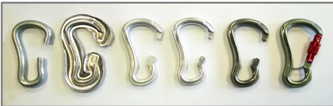
Obr. 2-10 Jednotlivé fáze výroby karabiny
