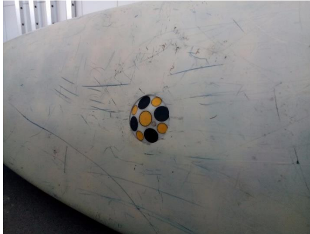
Obr.č.12 Dno deblkanoe, ve kterém je zapuštěn ADP modul tak, aby jeho hrana byla zároveň se dnem lodi (Zdroj: autor)
