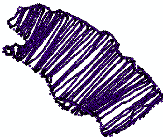
Obr.č.17 Vrstva obsahující 100 % naměřených dat s bodovou vrstvou břehové linie (Zdroj: autor)
