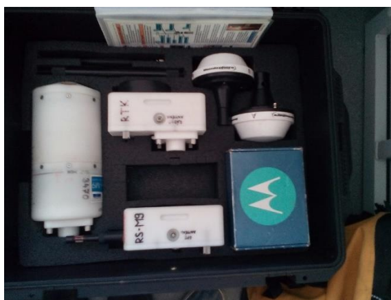
Obr.č.11 Měřící soustava RiverSurveyor v ochranném boxu (Zdroj: autor)
