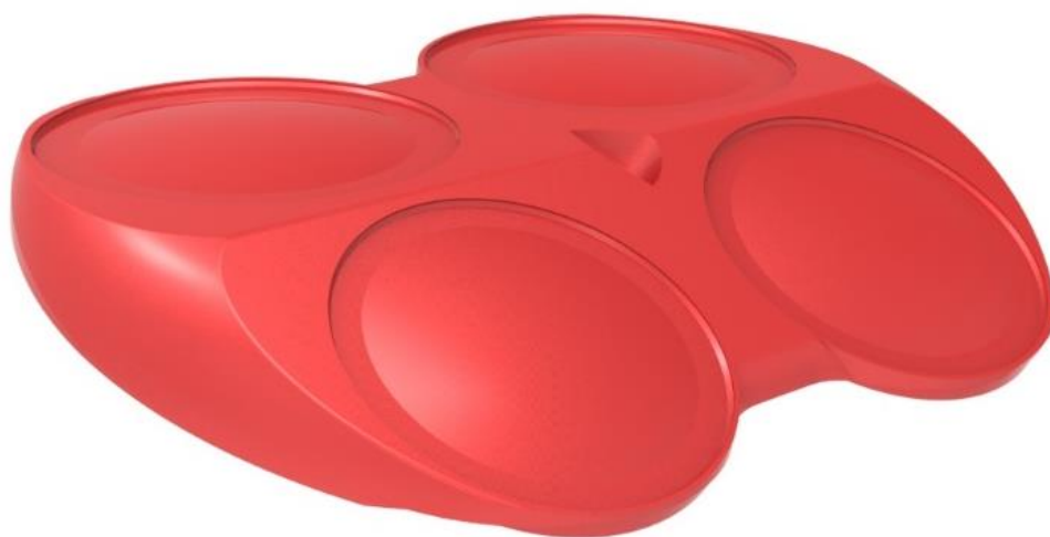
Obr. 38 Kompresní objem (pohled na ventily)
