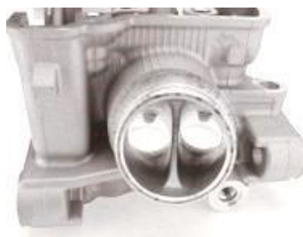
Obr. 11 Rozdvojení sání do dvou kanálů [6]
