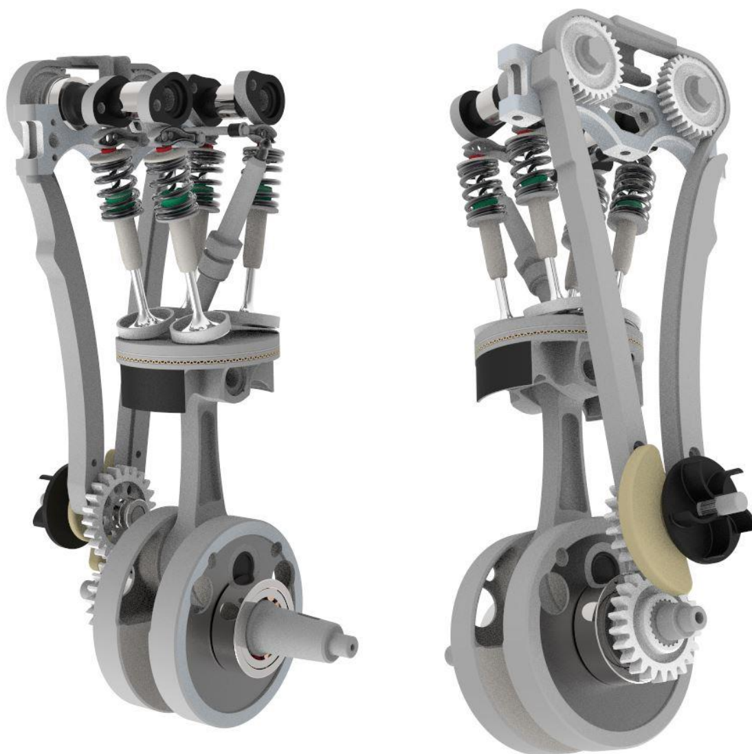
Obr. 57 Rozvodový řetěz, vodítka napínák řetězu
